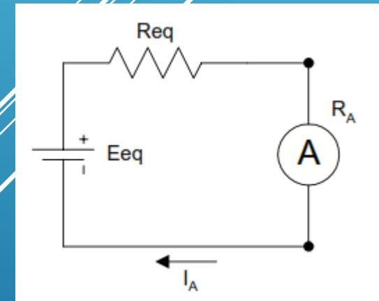
O Teorema de Thévenin estabelece que qualquer circuito linear visto de um elemento (ponto) pode ser representado por uma fonte de tensão  $E_{eq}$  (igual à tensão do ponto a analisar em circuito aberto), em série com uma resistência  $R_{eq}$  (igual à resistência equivalente do circuito vista deste ponto, com todas as fontes de tensão substituídas por um curto-circuito).
