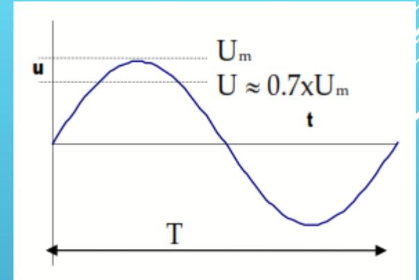
A maior parte dos multímetros TRMS baseiam-se no efeito térmico para determinar o valor eficaz da grandeza (tensão ou corrente). Utilizam normalmente uma resistência que aquece proporcionalmente à tensão (ou corrente) aplicada e, por intermédio de um transdutor de temperatura (termopar, normalmente), conseguem determinar o valor eficaz da tensão ou corrente. No fundo, seguem a própria definição de valor eficaz de uma grandeza (efeito térmico):
