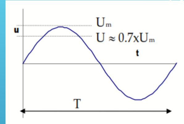
Em um multímetro comum o valor indicado só estará correto se o sinal for (puramente) senoidal ou em Multímetros de Verdadeiro Valor Eficaz (TRMS), se o sinal não for senoidal, o valor indicado representará apenas um valor proporcional ao valor médio desse sinal.
