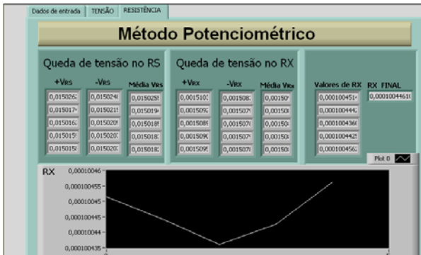
Figura 7 – Calculando o Vvc do Rx
