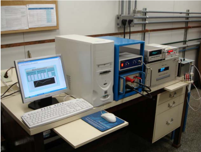
Figura 11 – Vista geral do sistema potenciométrico automatizado
