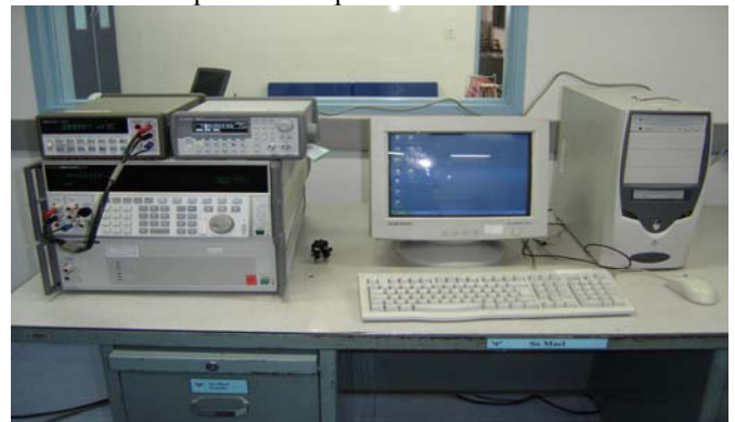
Fig 3 - Sistema automático de calibração de multímetros
