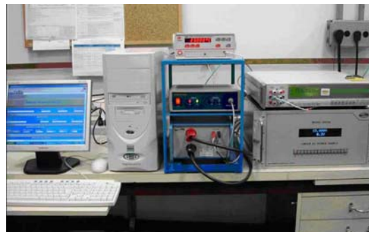
Fig. 3 - Sistema para calibração de resistores / shunts com altos valores de corrente – faixa de medição: de 100 \mu\Omega a 1 m \Omega até 100 A.
