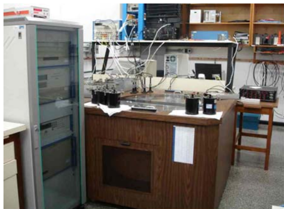
Fig. 1. Sistemas de medição de resistores padrão – faixa de medição: de 100 \mu\Omega a 1 G \Omega .
