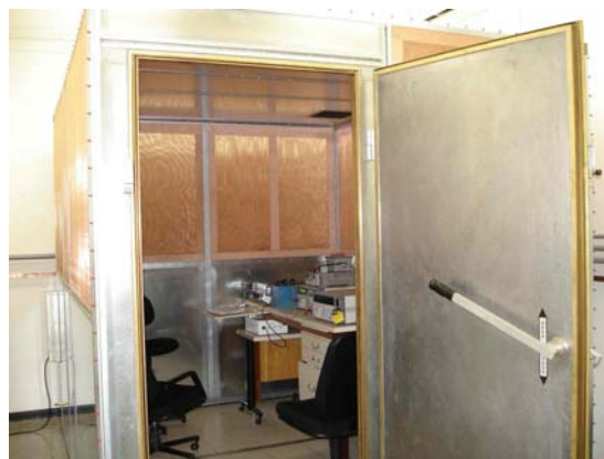
Fig. 4 - Gaiola de Faraday – calibração de medidor de resistência de altos valores - faixa de medição: de 1 M \Omega a 100 G \Omega .
